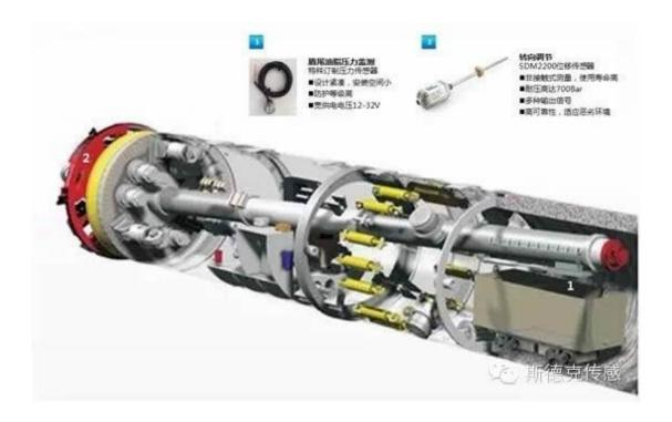
盾构机的前端需要高度准确的转向系统,来确保设备在地下几十米的黑暗环境中严格遵守既定的施工线路,Sendx的磁致伸缩位移传感器可以在系统的控制下,精确的执行系统指定,确保设备运行的位置和方向分毫不差。在整套设备的液压系统中,Sendx的压力传感器提供各个不同位置的精确压力值反馈,以保障设备正常运行。
