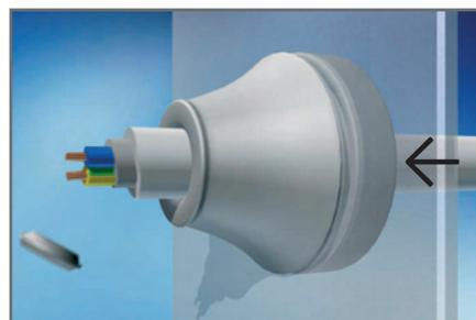
Führen Sie das Kabel durch die Dichtungsdurchführung.
